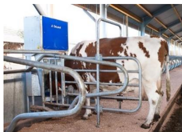
Foto 3. Distribuitor de concentrate cu senzor pentru identificarea vacii. Sursa: Delaval
