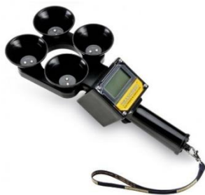
Foto 2. Ett exempel av en manuell konduktivitetmätare (Draminski®).
