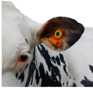
Foto 2. Sensor en crotal (SensOor). Fuente: Agis Automatisering
