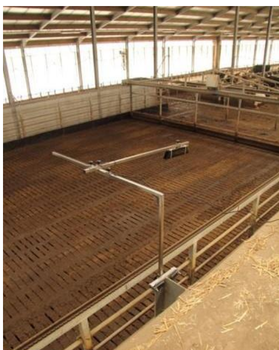
Foto 3: Instalación del sistema automático basado en imágenes 3D desarrollado por KU Leuven.
