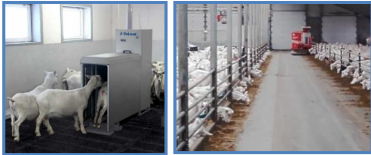
Foto 2. Izquierda: Ejemplo de un comedero automático individual para cabras. Fuente: DeLaval. Derecha: Ejemplo de un comedero automático para grupos. Fuente: Lely Vector.
